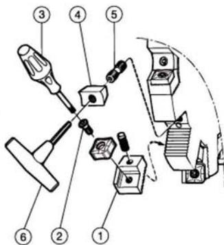
Bitte beachten, dass der Fräserdurchmesser sich bei Einsatz der 8-schneidigen Kassette um 3.2 mm erhöht.
